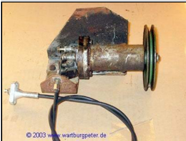
Und hier sieht man die Pumpe. Das meiste daran ist jedoch nur die Mechanik der Umlenkrolle und des Haltebleches. Die Pumpe, die daran befestigt ist, ist geradezu winzig klein.
