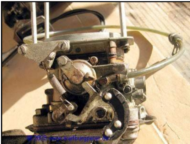
JiKOV 32 SEDR Vergaser mit Anschluß der Ölzuleitung.
