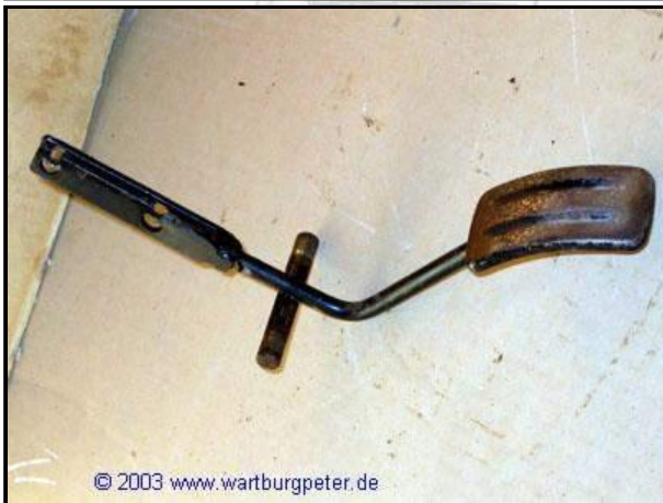
Beim Einsatz der Ölomatic-Anlage ist das Gaspedal zu ersetzen.
