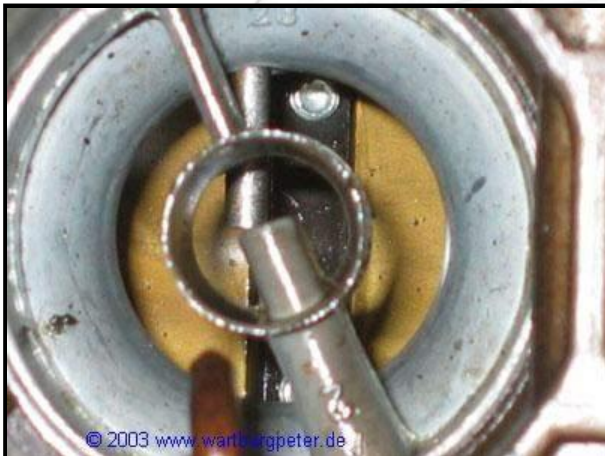
Von oben bzw. von unten in den Ansaugtrichter hineingeschaut, erkennt man das "Zerstäuberrohr" für die Ölzuführung.
